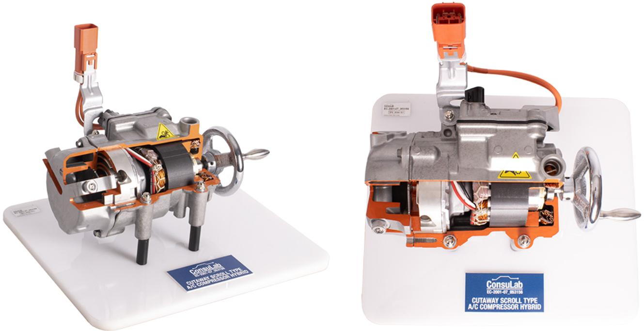
Compresseur de climatisation à spirale complet provenant d'un véhicule hybride moderne avec moteur électrique triphasé inclus. Le compresseur et le moteur sont découpés pour permettre aux élèves de voir le fonctionnement interne. L'unité peut être tournée à l'aide d'une manivelle. Comprend le connecteur de câblage haute tension orange et le faisceau de câblage.
